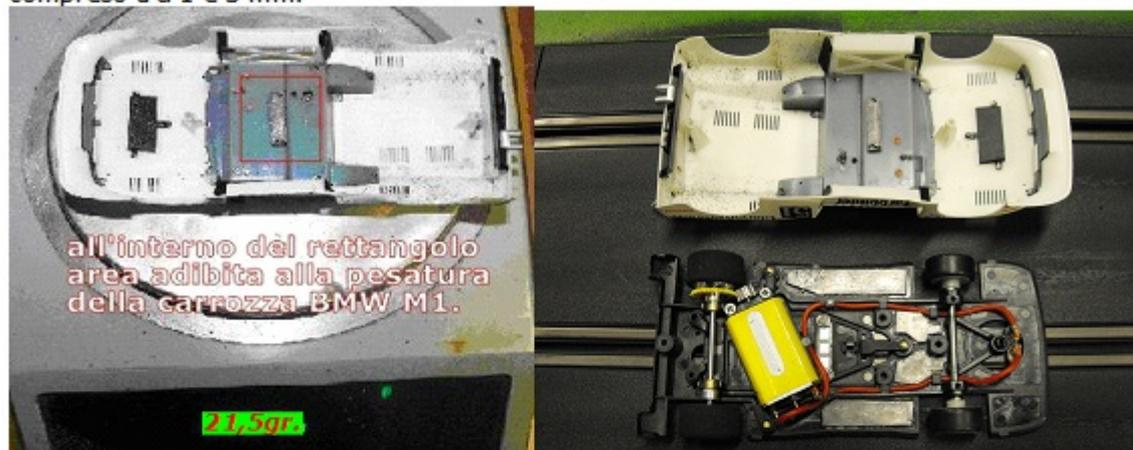
L'abitacolo e gli eventuali interni devono essere stabilmente fissati al corpo della carrozzeria. Nei modelli in cui l'albero motore interferisce con l'abitacolo, è ammesso ricavare una nicchia nell'abitacolo stesso con le dimensioni minime necessarie per permettere il passaggio dell'albero motore.
